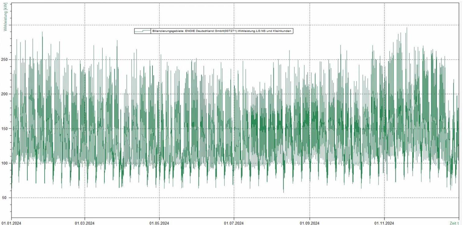
Bild 2: Lastverlauf NS als viertelstündliche Leistungsmessung
